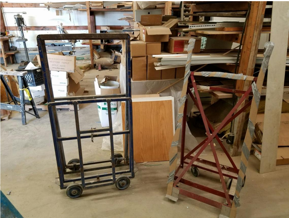
Drywall & Door carts
